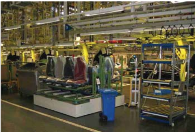
Die Bereitstellung der Sitze am Verbaort muss innerhalb klar definierter Zeitfenster erfolgen.
