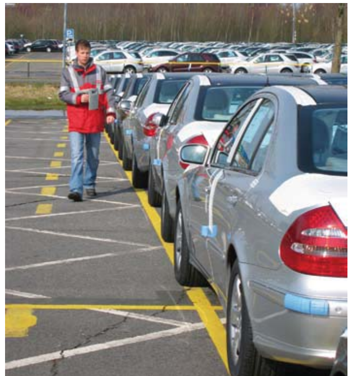
Automatische Inventur mittels Hybrid-MDE: Bis zu 20 Byte mit Fahrzeug- und Auftragsdaten können im Vorbeigehen problemlos erfasst werden.
