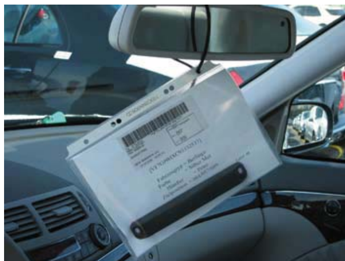
Passive Transponder (hier mit Testdaten) am Innenspiegel ermitteln die Passagerichtung des Fahrzeuges.
