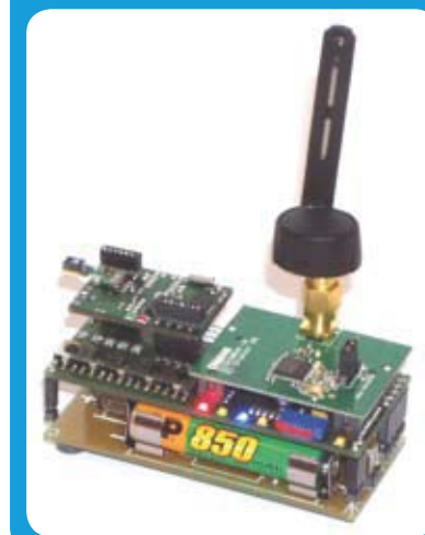
So sieht der Prototyp des „Intelligenten Containers“ aus: Auf der linken Seite befindet sich der RFID-Reader, in der Mitte zwei Sensorknoten. Ein scheckkartengroßes Prozessormodul an der rechten oberen Rückwand führt für jede Warenart einen Assistenten zur Überwachung des Transportes aus.
