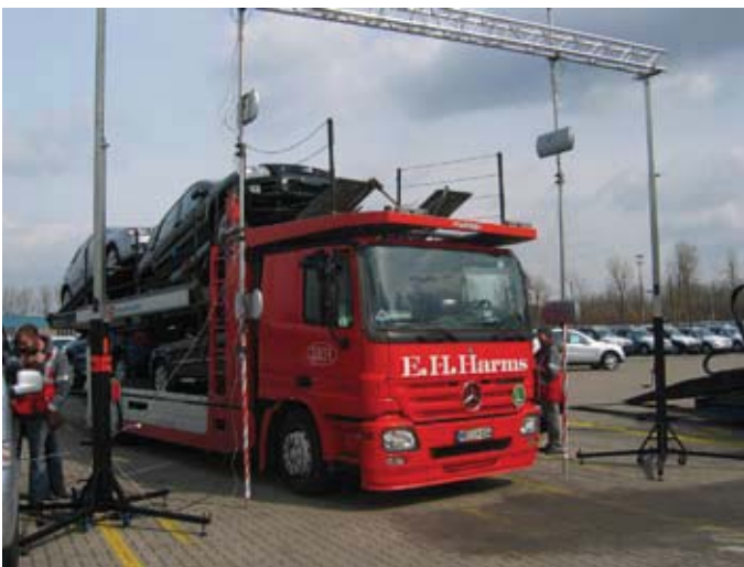
Identifikation im Außenbereich: Das Gate mit stationärer Antennen-/Reader-Kombination erfasst die getaggten Fahrzeuge auch auf dem Lkw.
