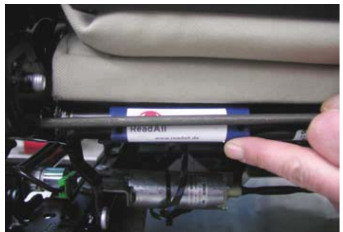
Sitz mit Gedächtnis: Der Transponder begleitet, unter dem Fahrersitz befestigt, die Reise durch alle Prozessschritte.
