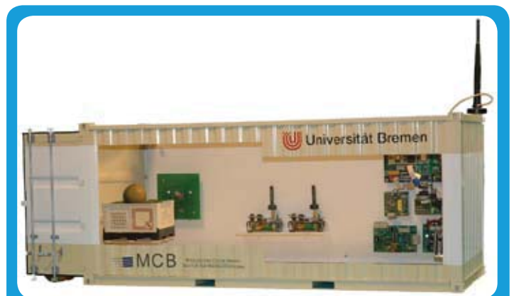
So sieht der Prototyp des „Intelligenten Containers“ aus: Auf der linken Seite befindet sich der RFID-Reader, in der Mitte zwei Sensorknoten. Ein scheckkartengroßes Prozessormodul an der rechten oberen Rückwand führt für jede Warenart einen Assistenten zur Überwachung des Transportes aus.
