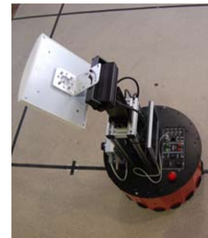
Transponder und Markierungslinien auf dem Boden ermöglichen dem Roboter die Orientierung.
