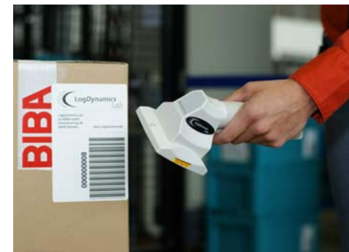
Einsatz des i-Scan UHF von Feig Electronic zum Scannen eines Paketes
