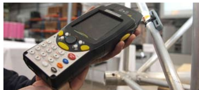
Durch Scannen mit dem mobilen Gerät werden die Vollständigkeit der zu verladenden Vermietartikel sowie Defekte oder Beschädigungen dokumentiert.
