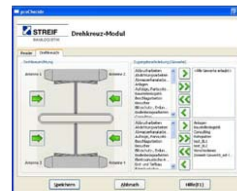
Die Steuerung der Drehkreuze erfolgt softwaretechnisch über ein Web I/O-Interface, welches die gesamten Steuerungsmechanismen beinhaltet.
