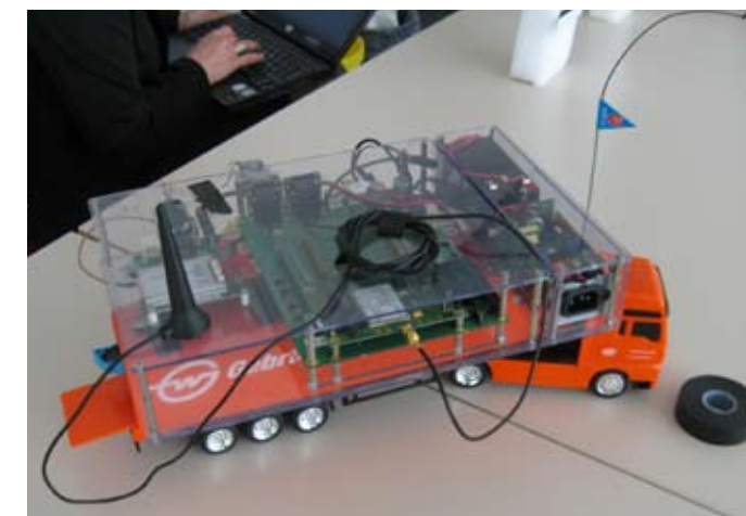
Die mobile Einheit des EURIDICE-Demonstrator – ein Lkw mit RFID-Tags und Sensoren
