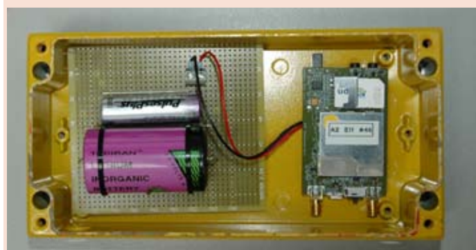
Die Yellowbox ist für die Datenakquise verantwortlich und sendet Wechselbehälterdaten, beispielsweise Geokoordinaten, an die Software (Middleware). Diese verarbeitet die empfangenen Daten zu Informationen und leitet diese an die operativen IT-Systeme der verschiedenen Anwender weiter.
