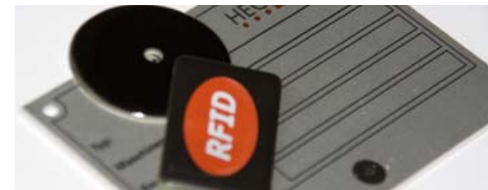
Das elektronische Typenschild bringt Daten auf den Punkt: Nur der RFID-Tag klebt darauf.
